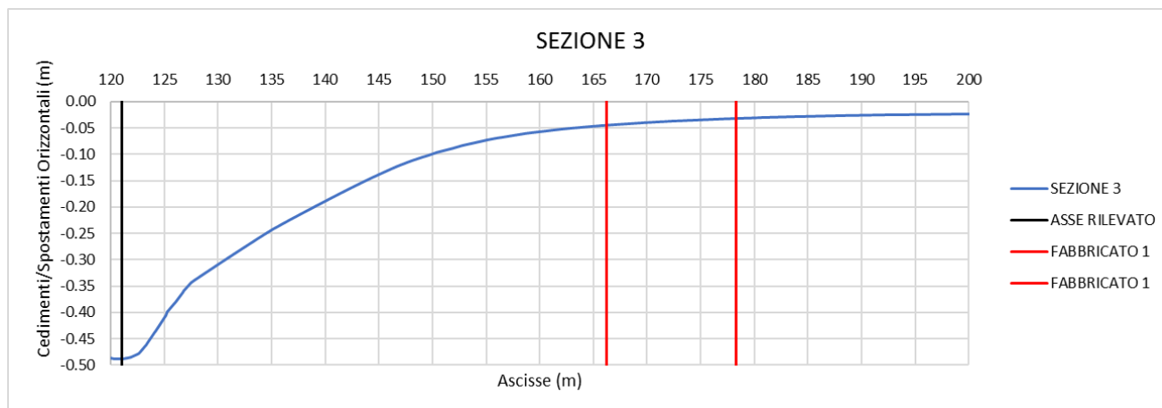
Figura 355 – EDIFICIO 1 – distribuzione dei cedimenti – Sezione 3
