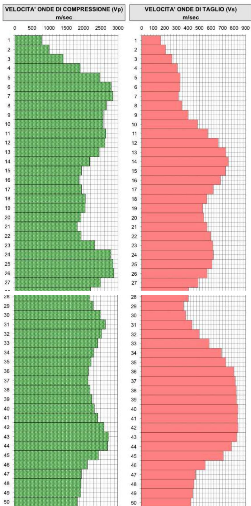
Figura 41 – Distribuzione delle onde di compressione e di taglio all'interno della DH-S1PG
