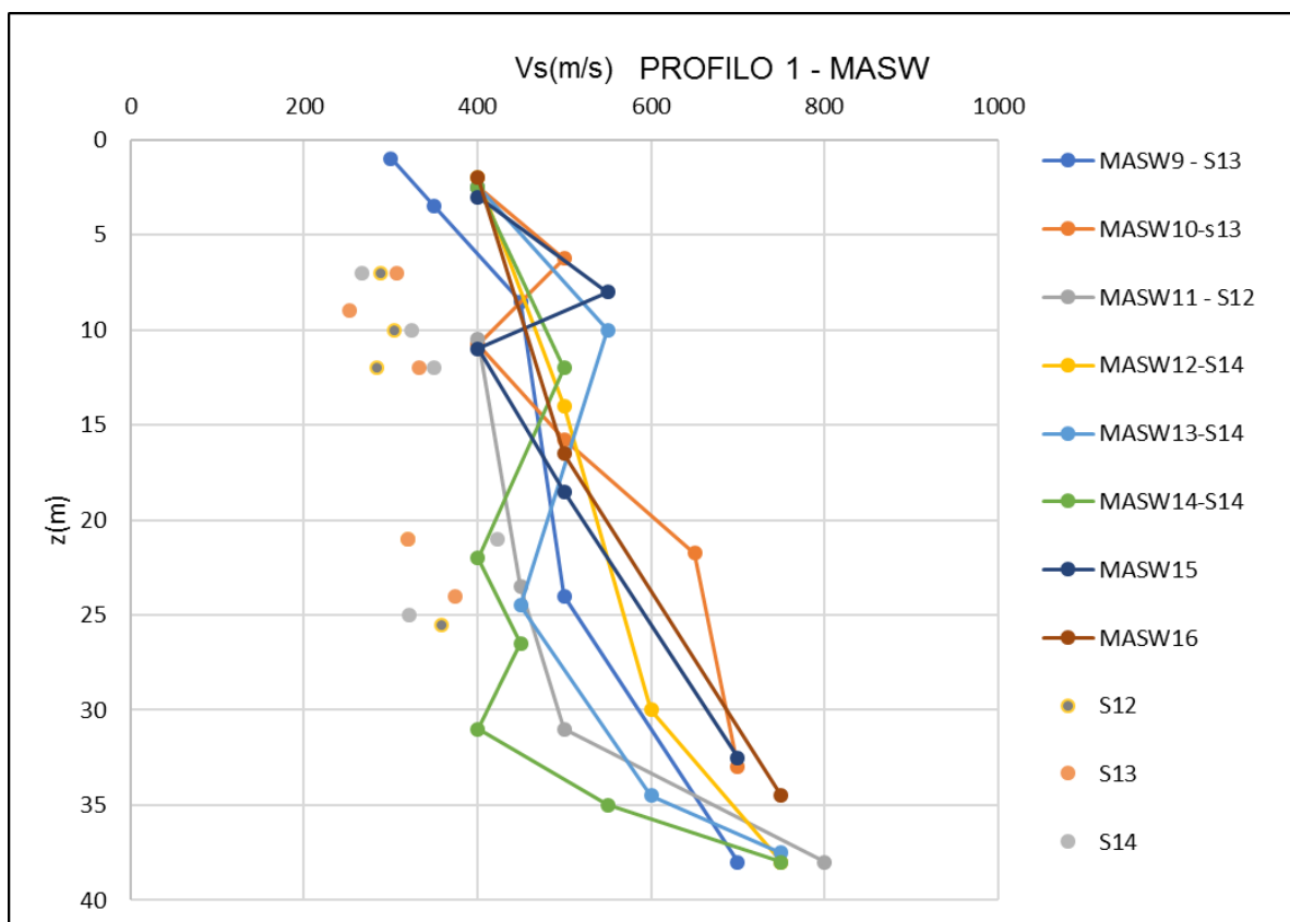
Figura 53 – Distribuzione delle Vs con la profondità UG2A – Profilo 1
