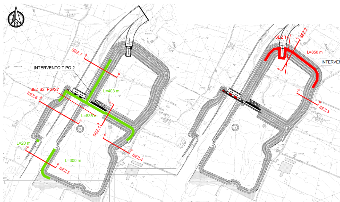
Figura 289 – Sezioni di calcolo e tratti in jet-grouting
