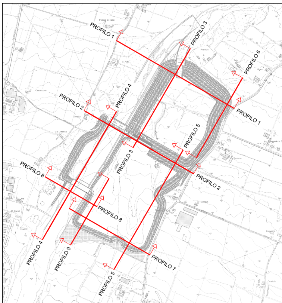
Figura 50 – Profili geotecnici lungo i quali è stata effettuata la zonizzazione della caratterizzazione geotecnica
